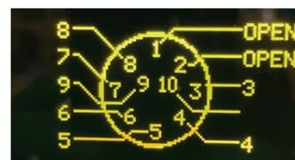
Se verifican las conexiones de los cables y se muestra el estado (solo 8870N)
