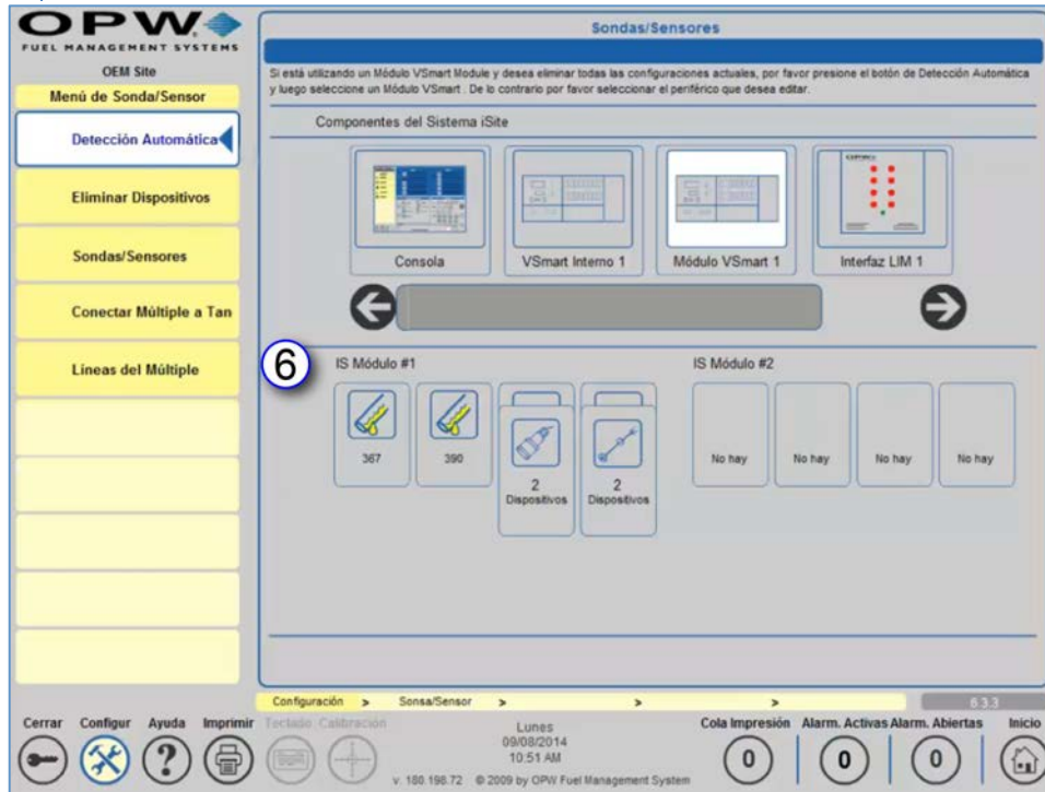
Figura 2-2 Dispositivos Conectados a la Posición de la Barrera I.S.
